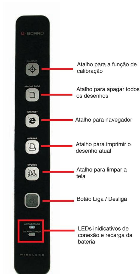
Figura 5 - Botões de atalho do receptor Station e LED indicadores
