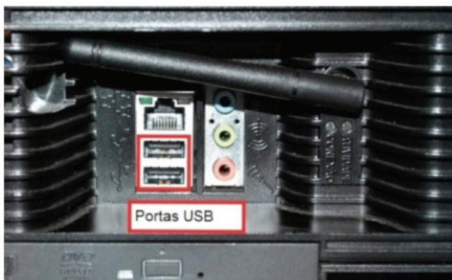
2. A Figura abaixo mostra como fica o transmissor sem fio conectado à porta USB do Projetor Interativo. Qualquer uma das portas USB pode ser utilizada.
